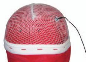
3) Posizionare gli elettrodi attraverso i fori della rete
